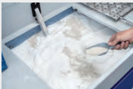
Beimischung des Spaltpulvers
