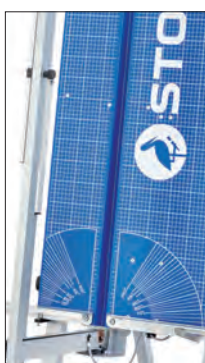
Gut ablesbare Mess-skalen für rationellere Zu- und Wiederholungs-schnitte
