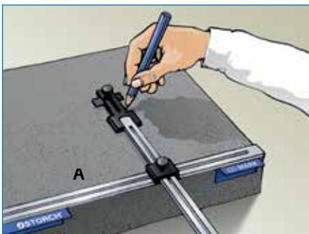
Posizionare il modello con l'arresto orizzontale (A) a livello con il pannello isolante e apportare le marcature di taglio.
