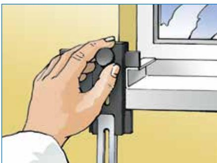
Přesuňte přestavovací zarážku (D) ke stanovení horní hrany parapetu a také překrývání izolačního materiálu s ukončovacím profilem parapetu.
