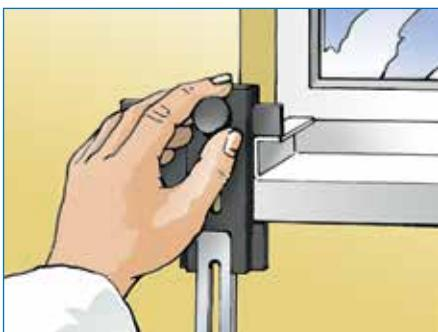
Verschuiven van de verstelschroef (D) om de bovenkant van de vensterbank te bepalen, plus de overlapping van het isolatiemateriaal met het afsluitprofiel van de vensterbank.
