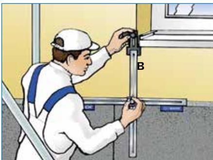
Přesuňte svislý doraz (B) doprava až k parapetu a nahoru ke stanovení dolního okraje parapetu.
