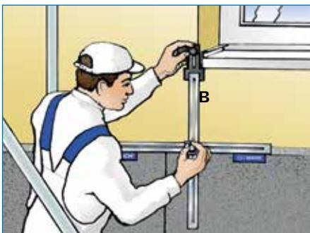
Verschiebung des vertikalen Anschlags (B) nach rechts bis zur Fensterbank und nach oben zur Festlegung der Fensterbank-Unterkante.
