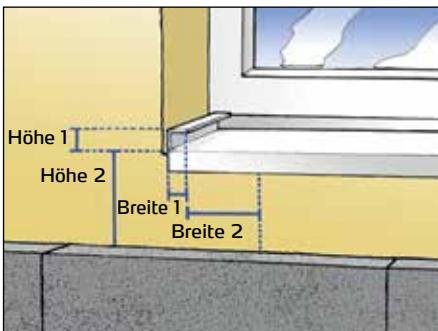
Der Verarbeiter von WDVS-Systemen muss für Schnitte an Fensterbänken vier Maße an der Fassade abnehmen, um diese anschließend auf die einzupassende Platte zu übertragen.
