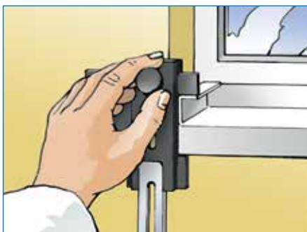
Déplacement du coulissoir de réglage (D) pour la détermination de l'arête supérieure de la banquette de fenêtre ainsi que le chevauchement du matériau isolant avec le profilé de raccordement de la banquette de fenêtre.
