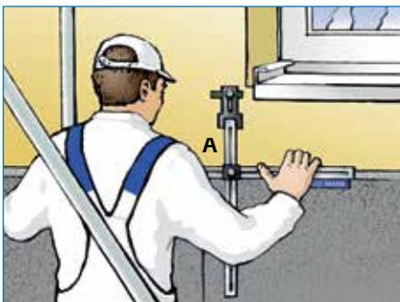
Přiložte vodorovný doraz (A) šablony na předchozí řadu izolačních desek při dodržení předepsaného přesazení desek.
