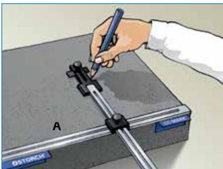
Sjabloon met horizontale aanslag (A) gelijk met de plaatrand op de isolatieplaat leggen en vervolgens de snijdmarkeringen aanbrengen.
