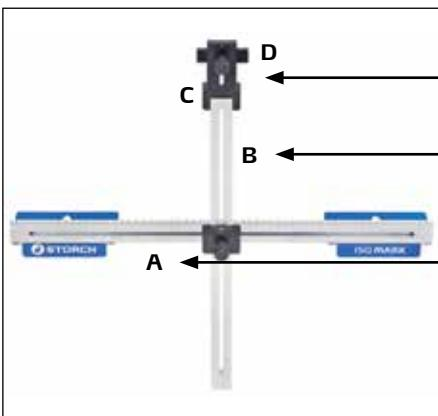
Messkopf (C) mit Verstellschieber (D)
