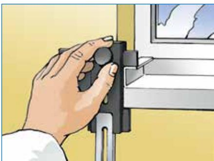
Spostamento del pattino scorrevole (D) per determinare il bordo superiore del davanzale e la sporgenza del materiale isolante sul profilato di copertura del davanzale.
