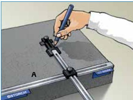
Schablone mit horizontalen Anschlag (A) bündig mit dem Plattenrand auf der Dämmstoffplatte anlegen und anschließendes Anzeichnen der Schnittmarken.
