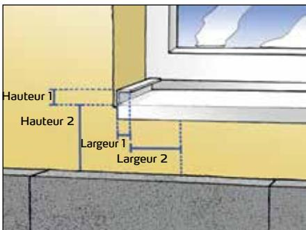
La personne qui manipule les systèmes thermiques composites doit prendre quatre cotes sur la façade pour les découper sur les banquettes de fenêtre pour les transférer ensuite sur le panneau à ajuster.
