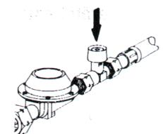
Entsperrknopf der Schlauchbruchsicherung nach Öffnen des (der) Ventil(e) drücken.
