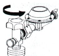
Klep(pen) voor stalen cylinder openen.
