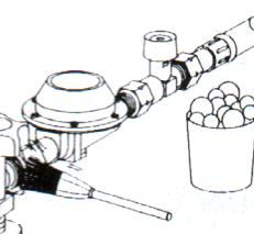
Nach Aufstellung und Anschluß der Geräte müssen alle gasführenden Verbindungen auf Dichtheit geprüft werden (Seifenlösung, Lecksuchspray).
