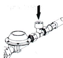
Bij gelijktijdig gebruik van meerdere gasflessen moeten alle kleppen geopend zijn.
