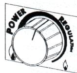
Regolare la potenza termoriscaldante con l'aiuto della "Power Regulation", con manopola a regolazione continua.
