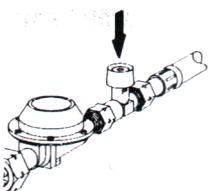
Esercitare pressione sulla manopola di apertura del raccordo antirottura per flessibili, solo dopo aver aperto ogni valvola.
