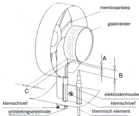
Aanwijzingen voor de instelling ( $\pm$  afmetingen in mm)
