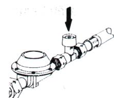
Après ouverture de la (des) valve(s), appuyer sur le bouton de déblocage de la goupille de sécurité.
