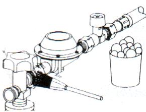
Una volta collocato e allacciato l'apparecchio occorre controllare se tutte le tubature del gas sono a tenuta ermetica (soluzione saponata, spray rivelatori di fughe ecc.).
