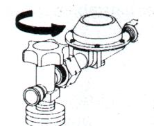
Ouvrir la valve de la (des) bouteille(s) de gaz.
