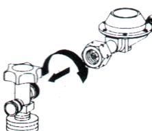
Raccorder le régulateur de pression à la (aux) bouteille(s) de gaz.
