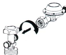
Druckregler an die Gasflasche(n) anschließen.
