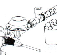
Lors du montage et du raccordement de l'appareil, l'étanchéité de toutes les connexions du circuit de gaz doit être contrôlée (solution savonneuse, spray détecteur de fuites).
