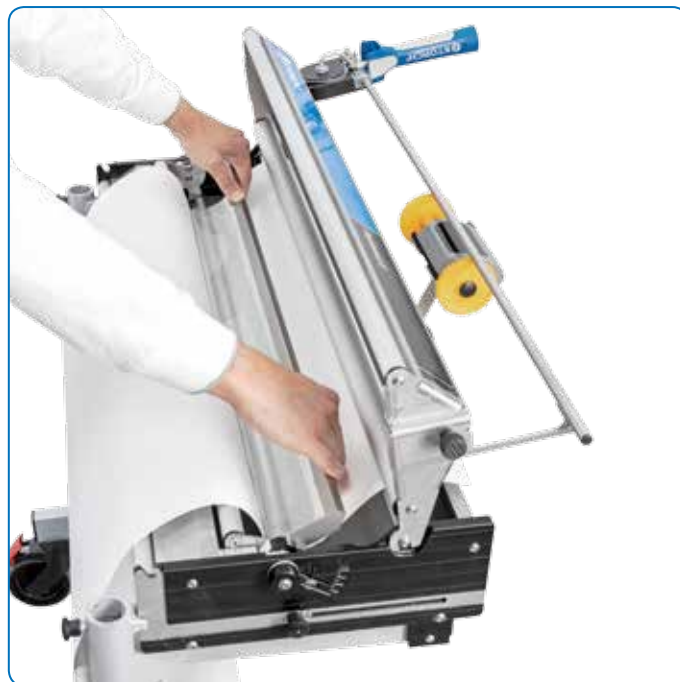
Einfaches Einlegen des Wandbelags
