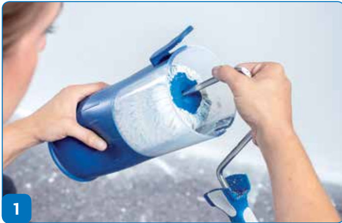
1 Walze von außen fassen, Bügel abziehen ...
